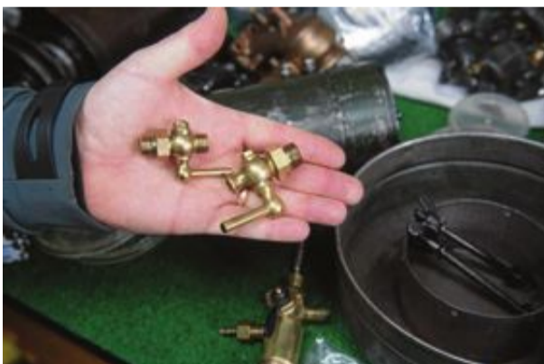
Gamla kranar som ser ut som konstverk. De ska sitta i en Munktells BM-21 med tändkulemotor.
